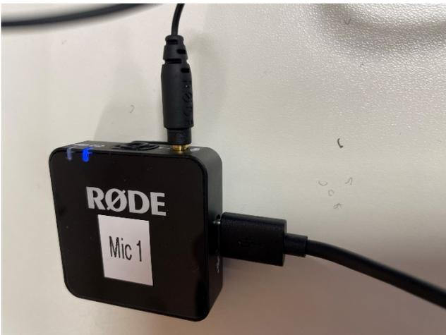
Bild 9 Rode Funkstrecken Empfänger
